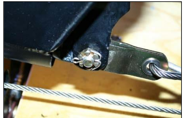
图 1 – 开口销正确的安装
